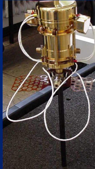
MUPUS – penetrator typu HEEP , Znajdujący się na kometcie Czuriumow-Gierasimienko
