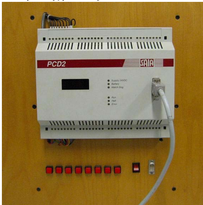
Rys. 2. Płyta czołowa ze sterownikiem PLC i 8 przyciskami dwustanowymi
